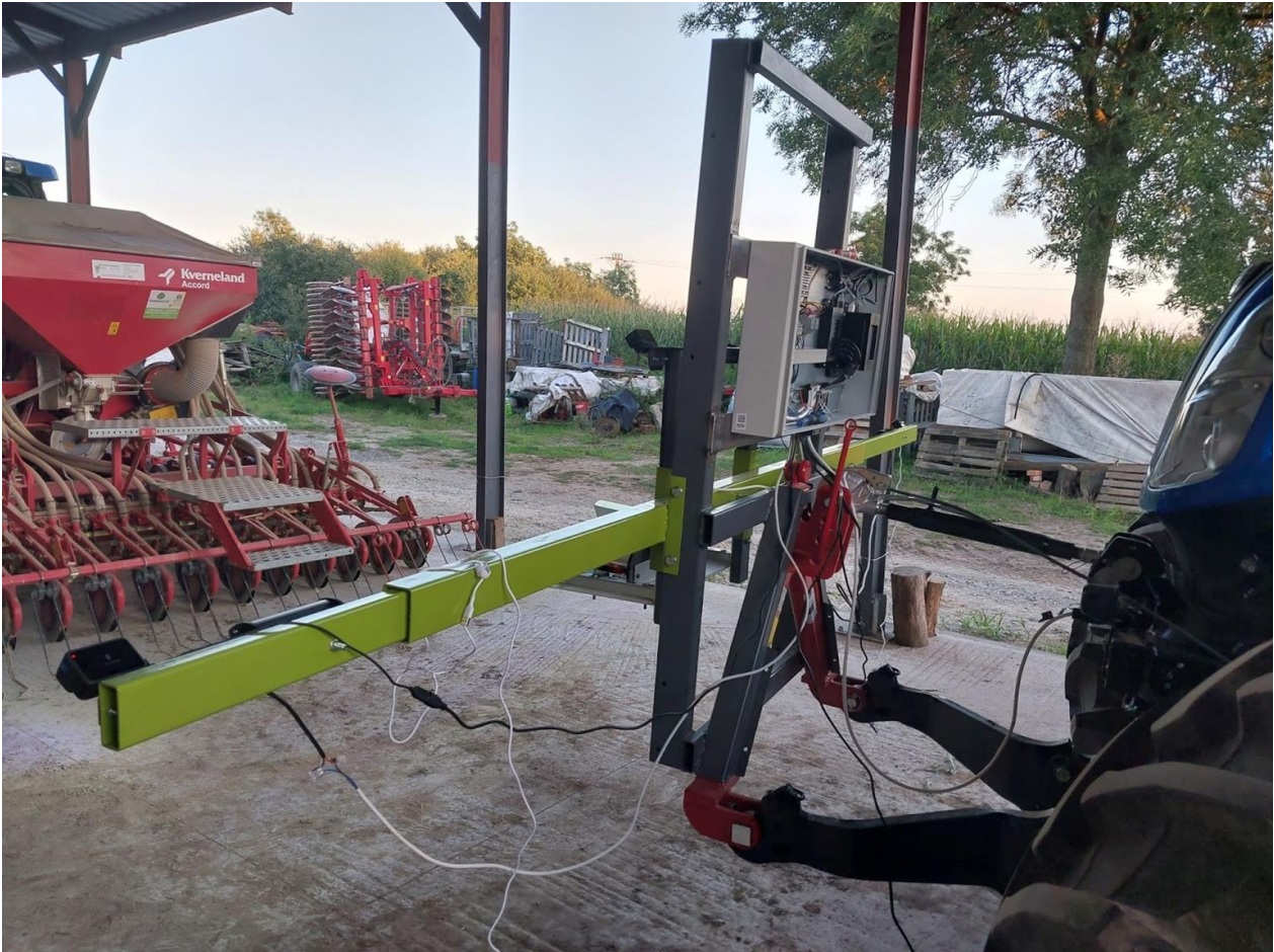
Ilustracja 3: Skrzynka z komputerem pokładowym, z boku widoczne kamery do zbieranie danych
