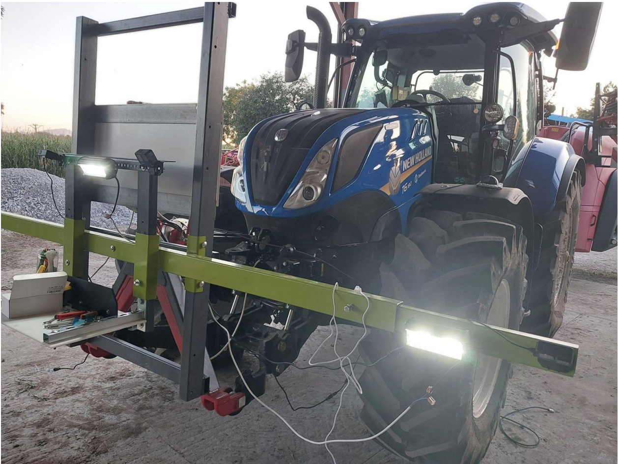
Ilustracja 1: Testowanie oświetlenia, widoczne kamery do zbierania danych, uchwyty do kamer wykonano przy użyciu technologii druku 3D
