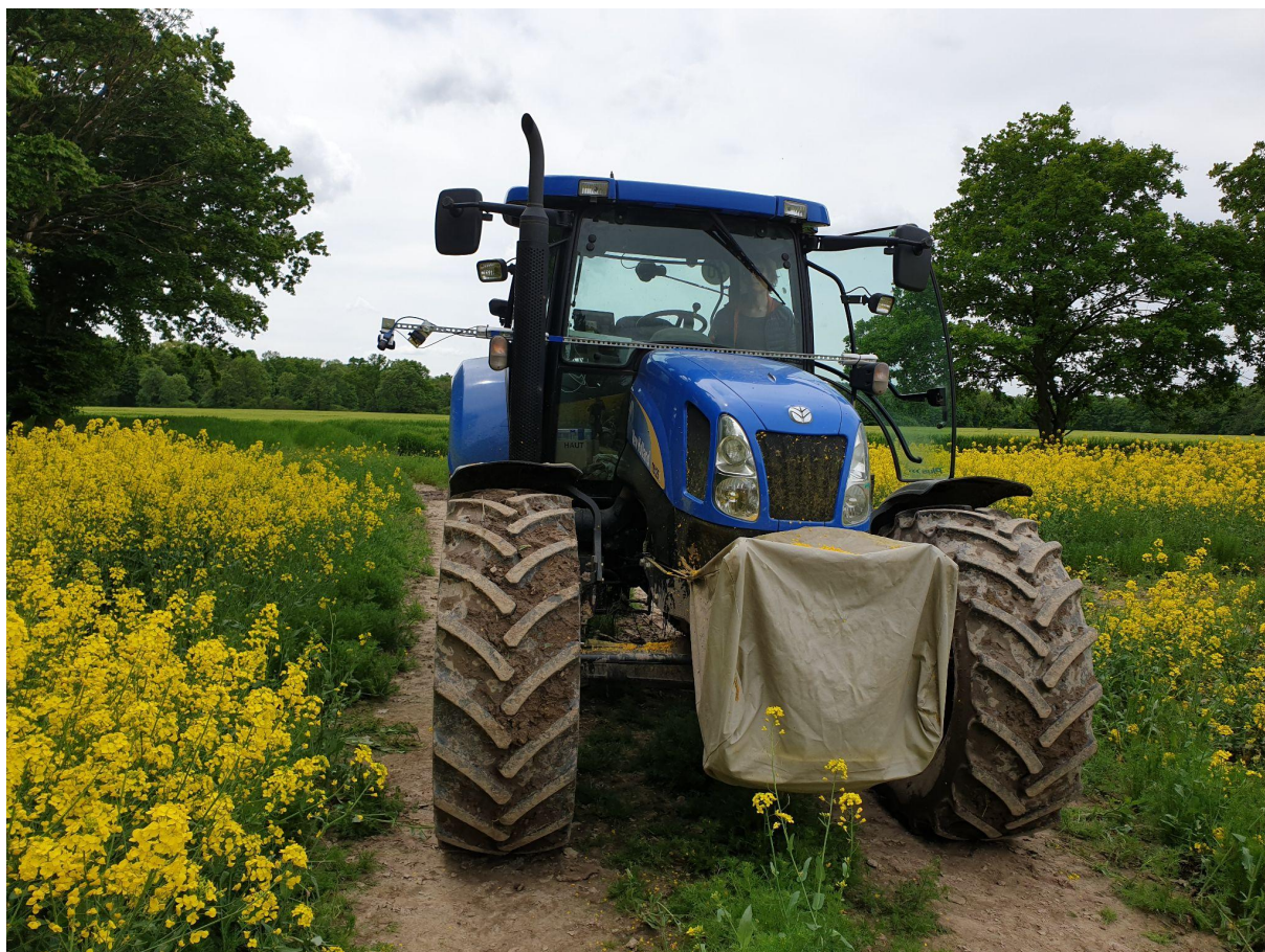
Zdjęcie 4. Traktor z zamocowanymi tymczasowo kamerami (K. Tomczuk, K. Ożarowski)
